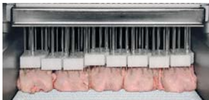
Разделенные на секции пневматические подошвы точно следуют контуру продукта, тем самым обеспечивая качественный процесс иньектирования, т. к. подошвы фиксируют продукт на месте. Эта система позволяет соблюдать заданную схему иньектирования: ни один участок не будет пропущен или иньектирован дважды.
