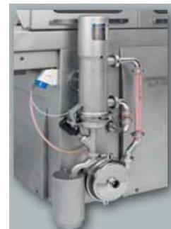
Самоочищающийся белковый фильтр FM 80 и высокопроизводительный насос центрифужного типа.
